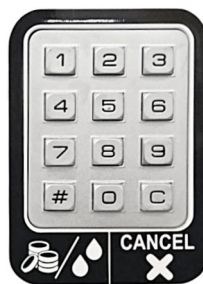
Obrázek 3 - 12ti tlačítková klávesnice předvolby
